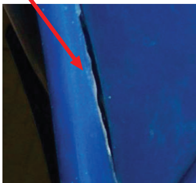
开裂 低劣的几何造型设计
